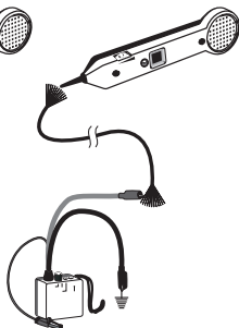
Figura 2b. Traccia del cavo
