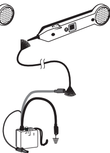
Figure 2b. Localisation d'un câble
